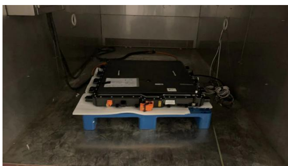
图 10 高海拔试验照片
